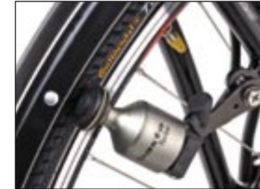
Abspeckkur: Der Basta-Reifendynamo ist leichter als ein Nabendynamo.
